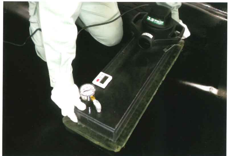
接合部負圧検査
