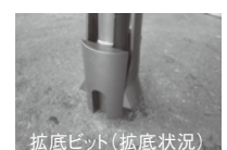
拡底ビット(拡底状況)
